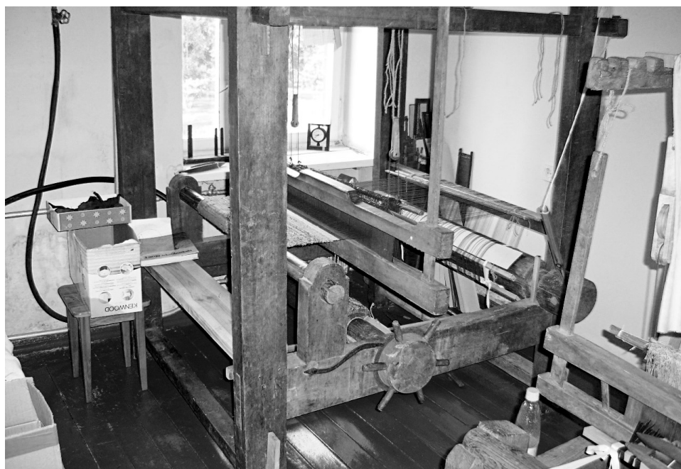
Krosno tkackie z prostym ręcznym mechanizmem przerzutowym, Indra (2. poł. XIX w.)
